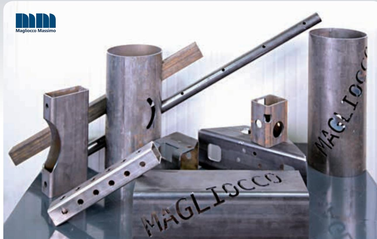
L'estrema versatilità della Mazak FABRI GEAR 300 consente di effettuare tagli, anche non longitudinali, su tubolari e profilati. Grazie alla rotazione della testa è possibile creare incastri e innesti con una inclinazione fino a 45°.
